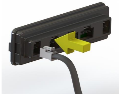
Rys. 7 Wpiąć wtyczkę przewodu nowego paska LED w gniazdo dwu-pinowe (to samo, z którego został odłączony uszkodzony pasek LED)
