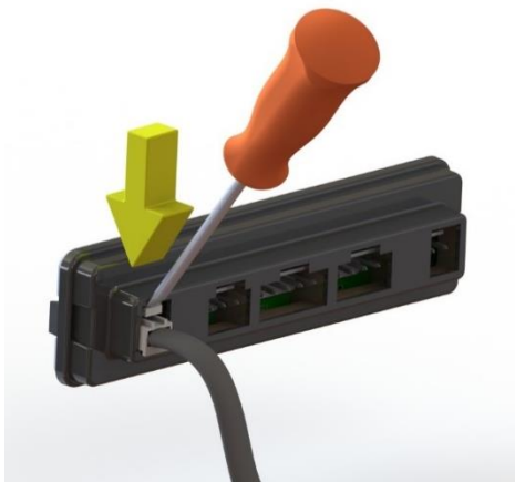
Rys. 4 Przy pomocy śrubokręta płaskiego wcisnąć pionowo w dół zatrząsk wtyczki
