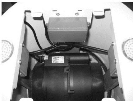
Fot. 2 Ulokowanie ceowników mocowania względem dolnego korpusu.
